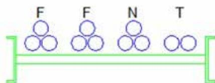
Conforme visto, na solução contíguo utiliza um leito superior a solução trifólio com a mesma quantidade de cabos, sendo recomendado, para a economia de custos e espaço em leitos, a solução trifólio.
