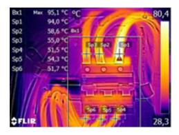
Por isso, é mandatório a utilização de terminais bimetálicos para conexão de cabos de alumínio flexível classe 5 em mini disjuntores.
